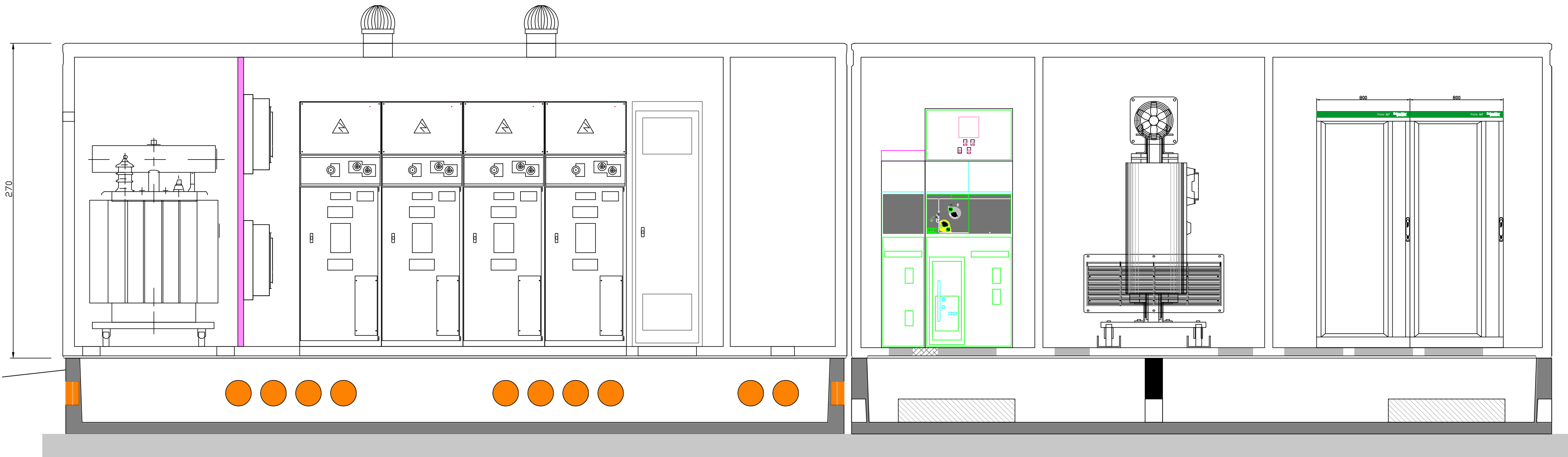
CABINA DI CONSEGNA MT: VANO ENEL - VANO MISURE - VANO CLIENTE - SEZIONE SCALA 1:20
